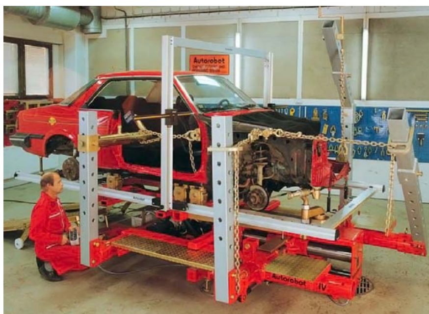
Il. 10. Widok systemu Autorobot IV obejmującego urządzenie pomiarowe i naprawcze
