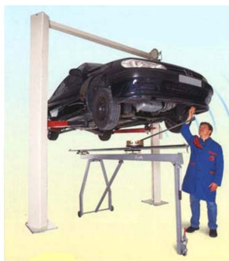
Il. 8. System pomiarowy NAJA i przykład zastosowania
