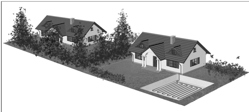
Il. 1. Pompa ciepła z poziomą instalacją ograniczającą ilość roślin na działce (opracowanie własne)
