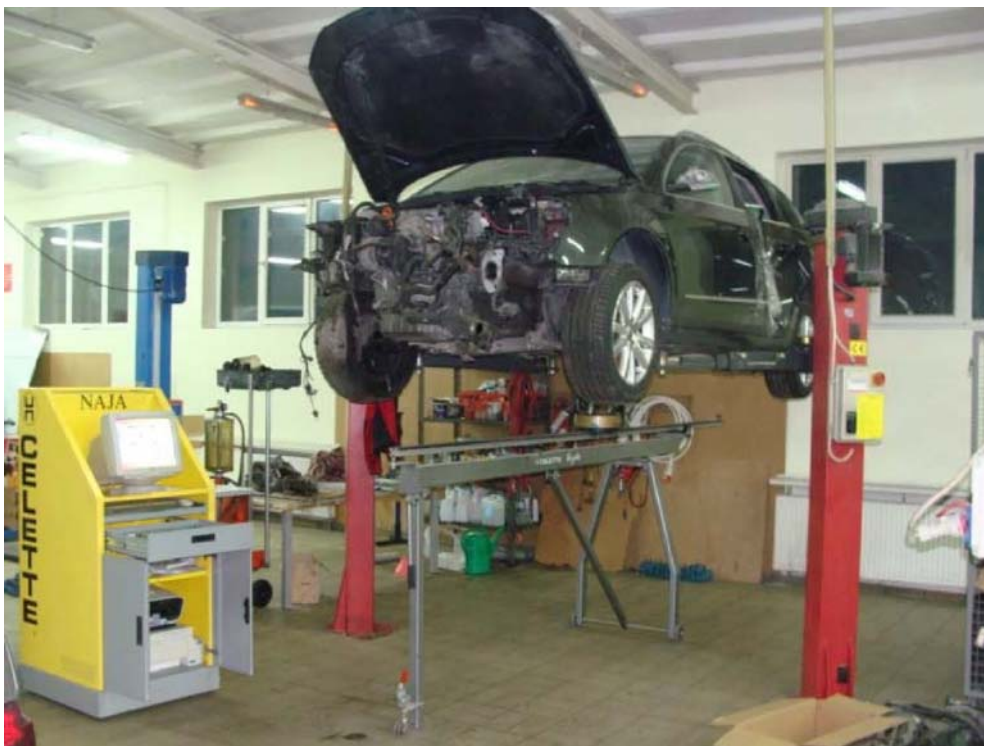
Il. 9. Badana karoserii samochodu VW Passat za pomocą urządzenia pomiarowego NAJA
