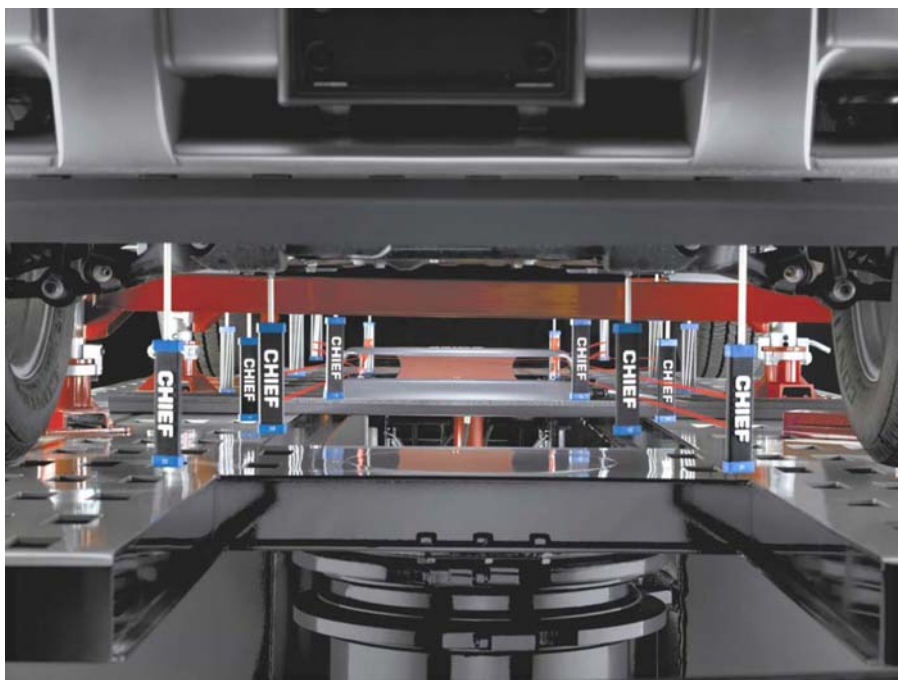
Il. 7. Rozmieszczenie sond pomiarowych i lasera skanującego przy pomiarze płyty podłogowej
