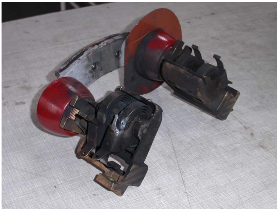
Il. 8. Pęknięta i przepalona sprężyna trzymadła szczotkowego
