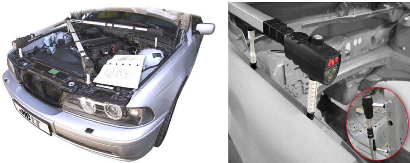
Il. 3. Przykłady pomiaru karoserii z użyciem urządzenia przenośnego eMC LT
