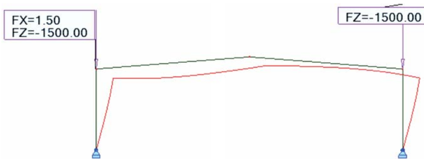
Rys. 5.1. Schemat obciążenia do obliczeń metodą przybliżoną
