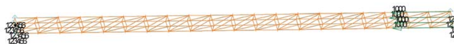
Rys. 17. Maszt zbudowany z 25 segmentów, ściskany założonymi siłami P=1000 N, działającymi wzdłuż pasów
