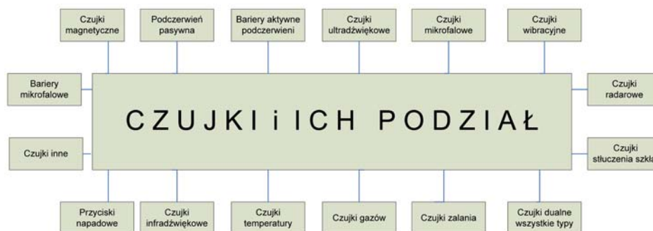
Rys. 1. Czujki stosowane w elektronicznych systemach bezpieczeństwa
