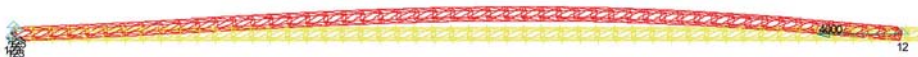
Rys. 8. Postać wyboczenia odpowiadająca obciążeniu krytycznemu wyznaczonemu na podstawie analizy nieliniowej dla t=0,65
