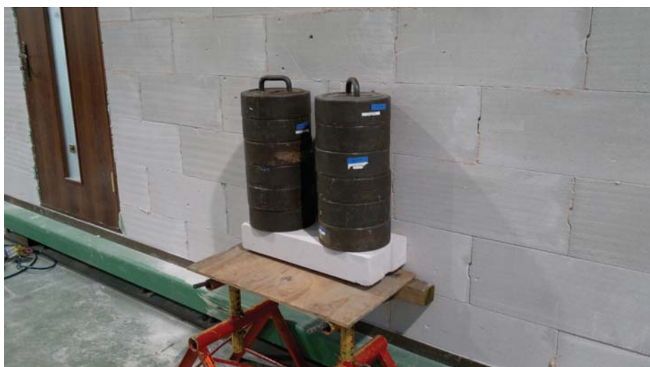
Fot. 5. Efekt połączenia betonu komórkowego na klej poliuretanowy podczas badań ściany działowej w ITB (obciążenie półki z płytki z betonu komórkowego, przyklejonej na klej poliuretanowy w areozolu – 300 kg – bez żadnych kotew, bez dodatkowych wzmocnień)
